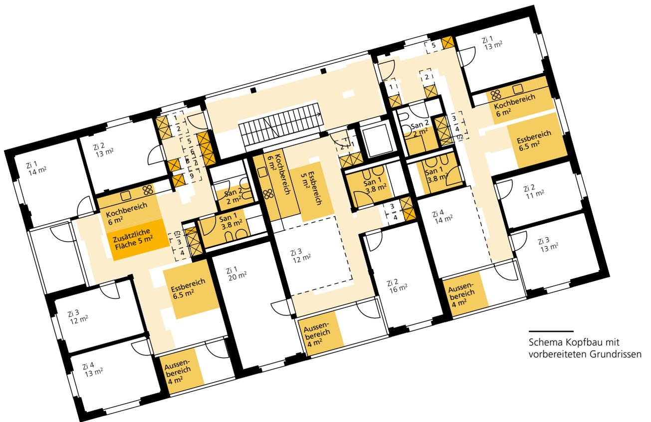
Schema Kopfbau mit vorbereiteten Grundrissen
